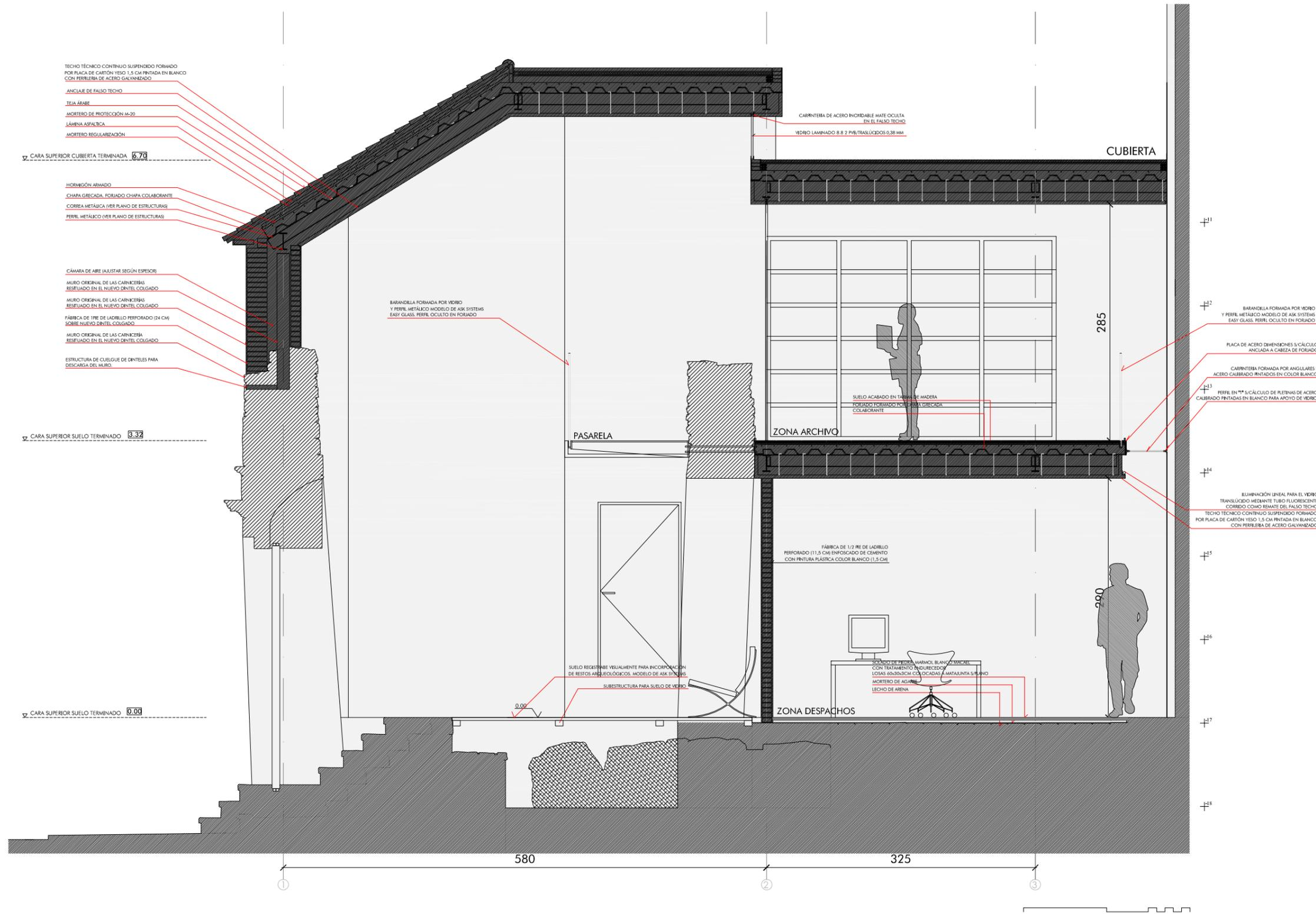
TECHO TÉCNICO CONTINUO SUSPENDIDO FORMADO POR PLACA DE CARTÓN YESO 1,5 CM PINTADA EN BLANCO CON PERFILES DE ACERO GALVANIZADO
