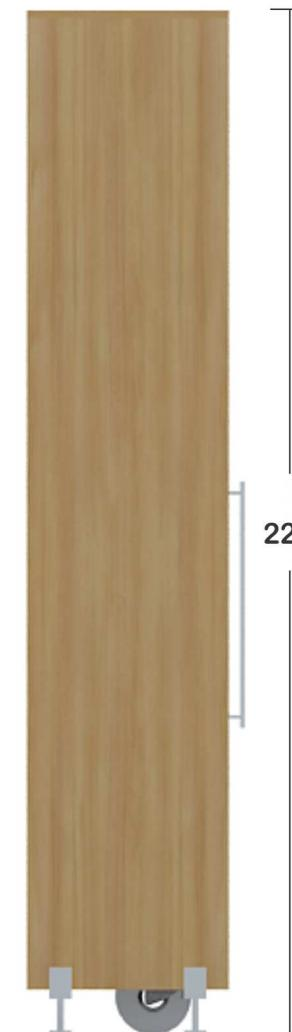
Sistema de estanterías compuesta por módulos de diferentes tamaños con puertas, las cuales, al abrirse dejan salir el módulo de estantes. De esta forma se facilita la búsqueda de libros y demás cosas que allí se guardarán. Cada módulo tiene una rueda en la base, de modo de facilitar el movimiento al abrirse la puerta con el peso de la estantería.
