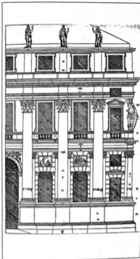
Fig. 31. A. Palladio, Palazzo Volmarano, Vicenza. Particolare di facciata. L'inserimento nel tessuto urbano preesistente avviene tramite l'inserimento di due ordini minori tra l'impaginato delle facciate dell'edilizia residenziale esistente e l'ordine gigante del palazzo patrizio.
