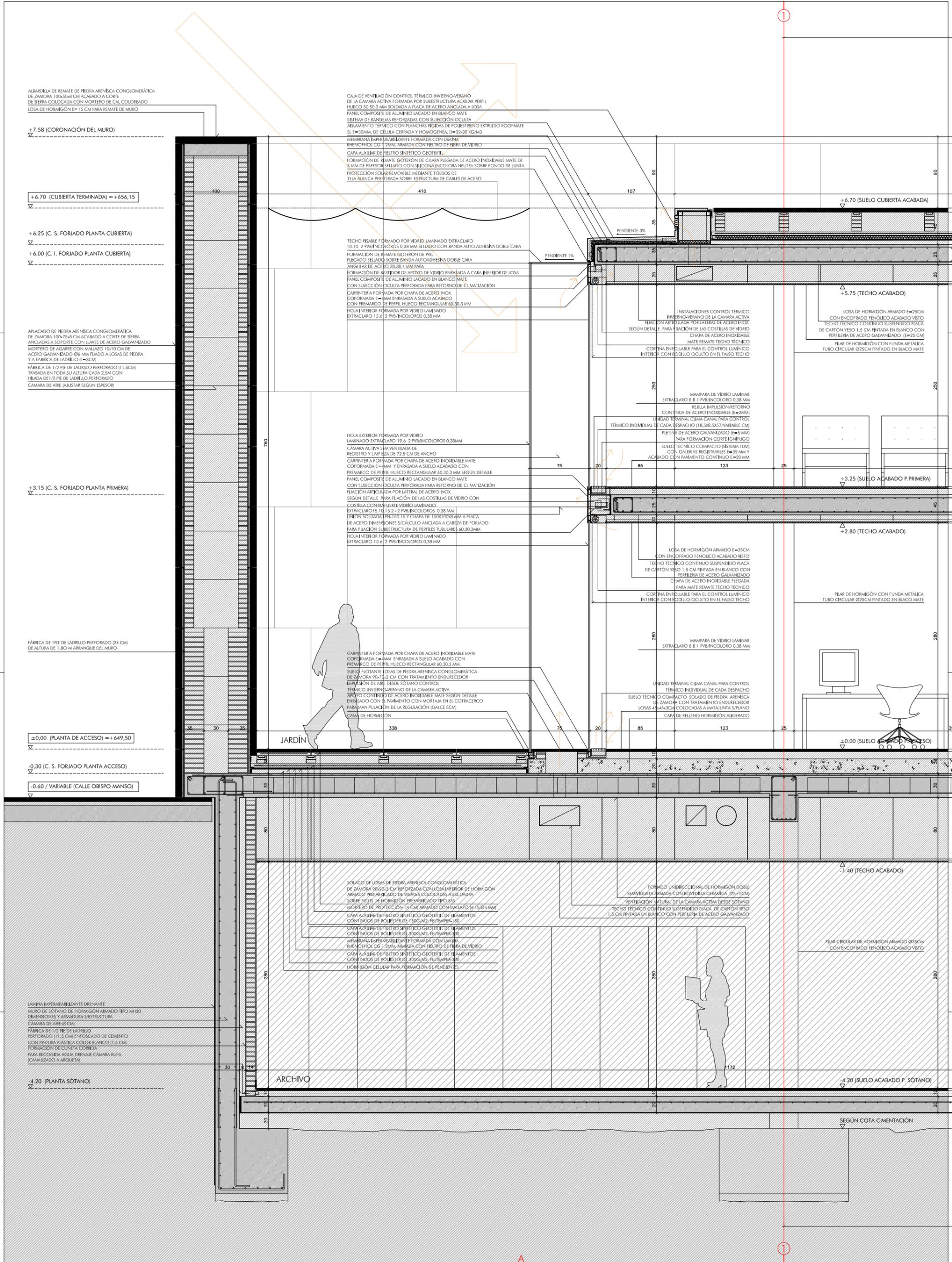
ALBARILLA DE REMATE DE PIEDRA ARENOSCA CONGLOMERÁTICA DE ZAMORA 100x50x8 CM ACABADO A CORTE DE SIERRA COLOCADA CON MORTERO DE CAL COLOREADO
