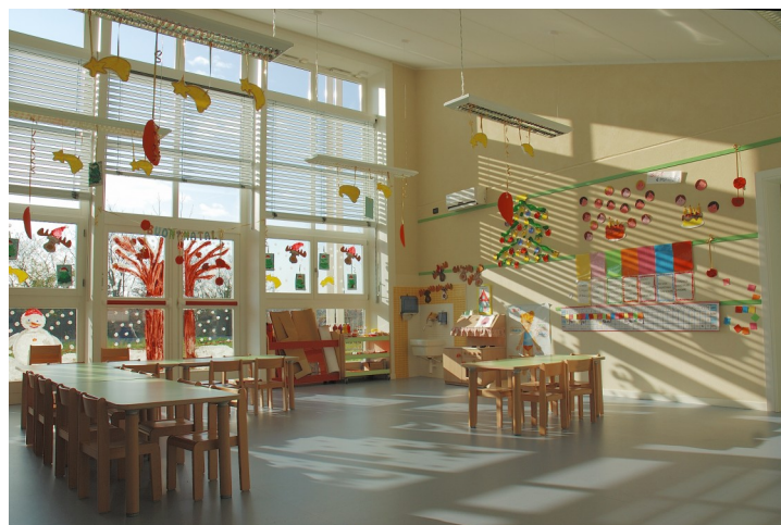
03 Scuola Materna di Contea a Montebelluna. Le grandi vetrate esposte a Sud forniscono calore e luce solare diretta e controllata, con consumi energetici molto ridotti.
