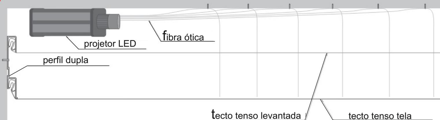
Para criar uma decoração (constelação mapa) sobre o "céu estrelado" tem de utilizar o segundo método. Para instalar este tecto falso é usado No. perfil duplo 9.
