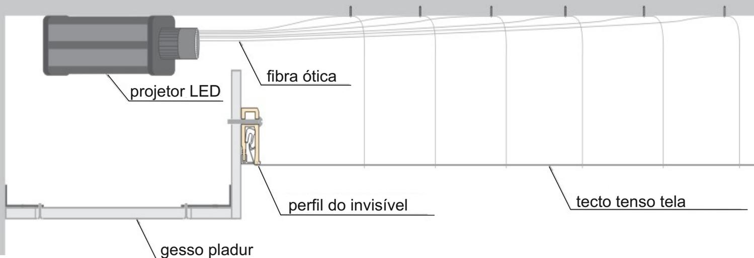
Tecto tenso «céu estrelado» com uma única tela. No tela de tecto tenso faz pequenos furos através dos quais é passado as fibras ópticas. O lado exterior fibras cortadas, deixando um comprimento de 1 a 2 mm. Esta tecnologia é apropriada para aplicar as texturas "grosso" (por exemplo, "camurça") que "escondem" fibras, quando não estiver ligado fonte de luz de fibra optica (ou seja, sem efeito de "céu").
