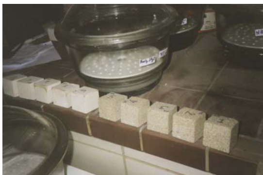
Εικόνα Δ.1 : Δοκίμια εργαστηριακών δοκιμών: Α) Κυλινδρικά και πρισματικά μαρμάρου Διονύσου, Β) Κυλινδρικά και πρισματικά παρόλιθου Ρεθύμνου, Γ) Κυλινδρικά και πρισματικά παρόλιθου Κύπρου, Δ) Κυλινδρικά και πρισματικά παρόλιθου Ρόδου, Ε) Κυβικά παρόλιθων Ρεθύμνου και Κύπρου, ΣΤ) Κυβικά παρόλιθου Ρόδου.
