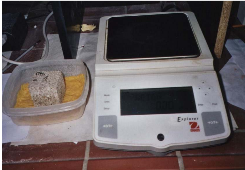
Εικόνα Δ.11 : Δοκιμή υδαταπορρόφησης δοκιμίου ΠΡΔ1
