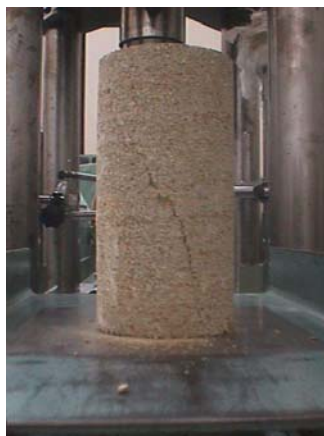
Εικόνα Δ.8 : Αστοχία δοκιμίων παρόλιθου Ρεθύμνου σε μονοαξονική θλίψη : Δοκίμια: A) ΠΡΚ1 , B) ΠΡΚ2 , Γ) ΠΡΚ3 , Δ) ΠΡΚ4 , E) ΠΡΚ5.
