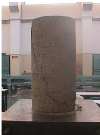
Εικόνα Δ.8 : Αστοχία δοκιμίων παρόλιθου Ρεθύμνου σε μονοαξονική θλίψη : Δοκίμια: A) ΠΡΚ1 , B) ΠΡΚ2 , Γ) ΠΡΚ3 , Δ) ΠΡΚ4 , E) ΠΡΚ5.
