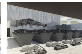
Interno dell'Impianto di Flottazione
