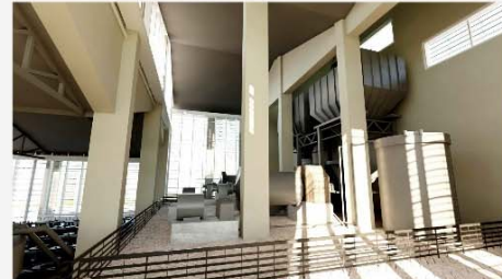
Vista Interna Impianto di Flottazione - Tramoggia raccolta del minerale
