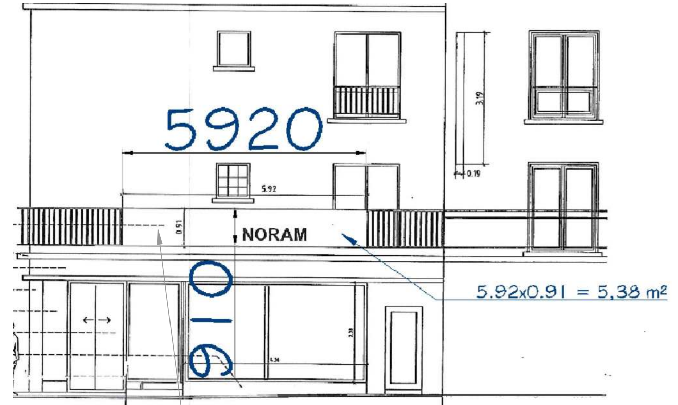
1 Enseignes bandeau fixé au garde corps
