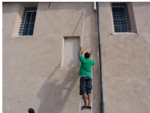
Posizionamento del segnalino e successivo calcolo con filo a piombo delle misure
