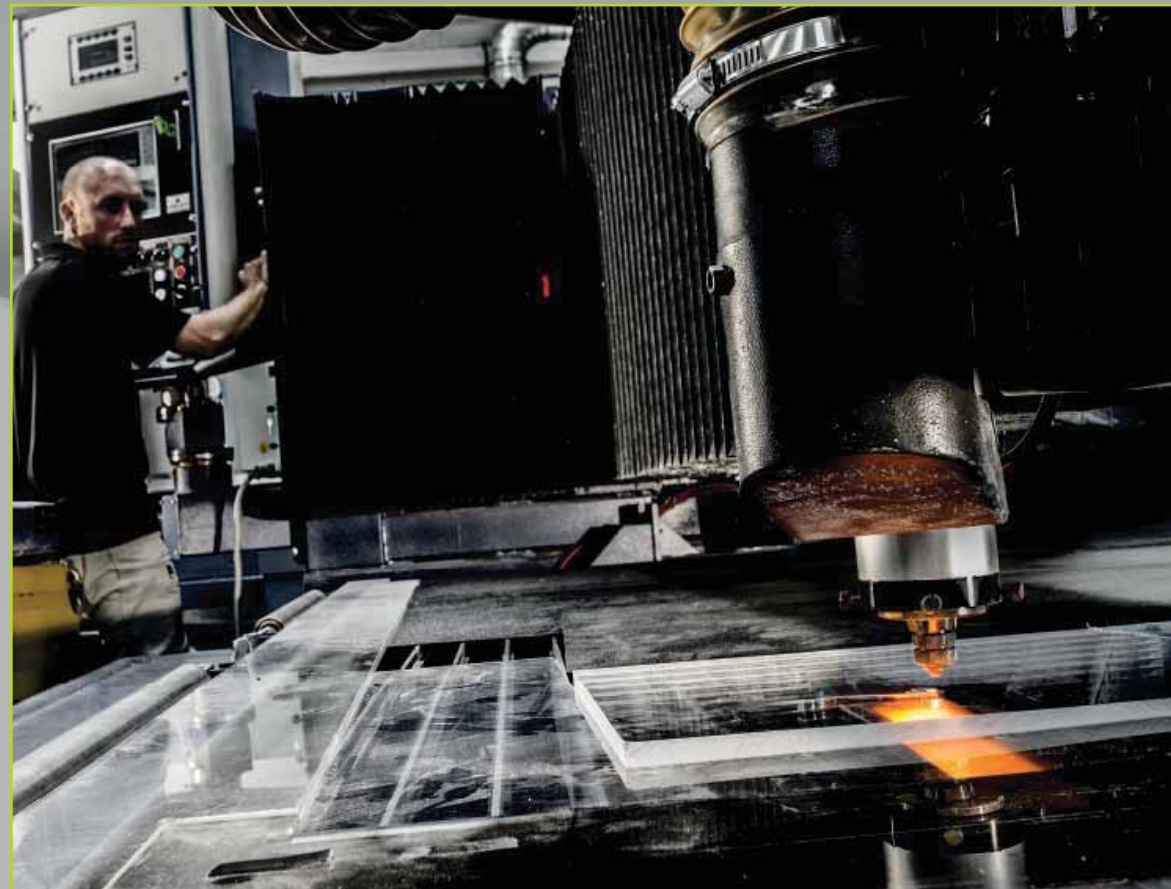
LAVORAZIONE SPECIALE diffusore da lastra con taglio laser SPECIAL MANUFACTURING PROCESS diffuser cut by laser from a plate
