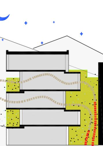
3\_ Por la noche, el **frescor del muro** regado y la **apertura del edificio** aseguran la **extracción del calor acumulado** durante el día lo que permite la **bajada de temperatura** del edificio.
