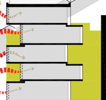
2\_ El **colchón térmico** creado entre la **fachada** y el **muro cortina** regula la temperatura, **evitando elevadas temperaturas** en verano.
