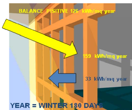
Figura n.1 La quantità di energia solare che entra attraverso una finestra verticale orientata a Sud, dotata di vetri di alta qualità, è maggiore di quella che viene dispersa nel medesimo periodo. Per la conservazione del calore è necessaria una ottima qualità dell'isolamento termico.
