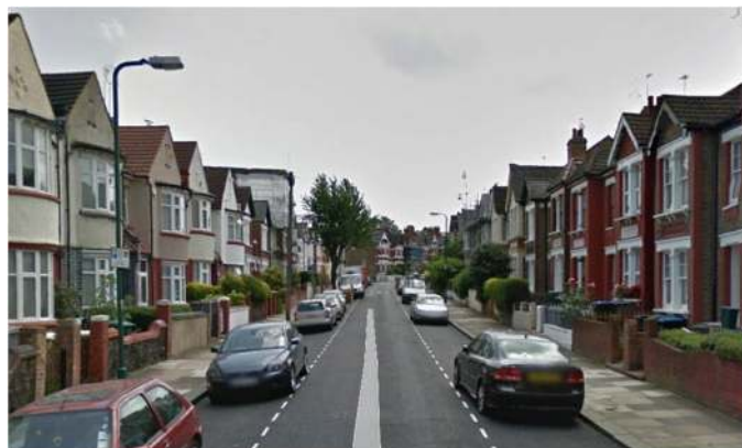
Isola ambientale a Londra con strada composta da una corsia centrale a due sensi di marcia di larghezza pari a ml 3,50 abbinata a due fasce laterali di parcheggio
