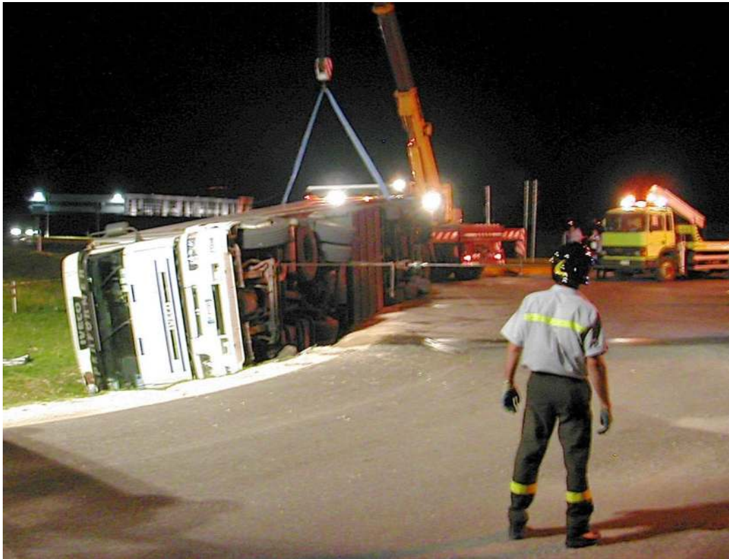
Un grande camion a pieno carico rovesciatosi in una rotatoria a causa della pendenza errata della corsia di marcia nell'anello
