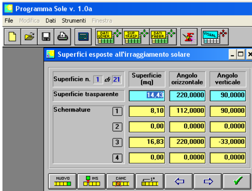
Fig. 77 - La maschera in figura ci permette l'inserimento delle grandezze geometriche e spaziali sia delle superfici trasparenti che delle schermature corrispondenti.
