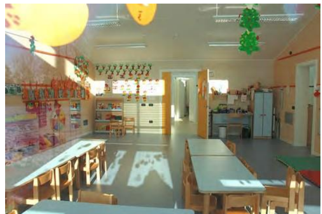
Fig. 57 - Le superfici interne delle murature in calcestruzzo di questa sezione di scuola materna sono state rettificare con un sottile intonachino e tinteggiate con colori chiari.
