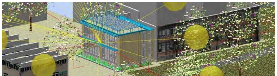
Fig. 52 b - La deviazione di 11° della facciata Sud rispetto al meridiano di questo ampliamento di scuola media, qui visibile nella fase di studio preliminare, conservata per allinearla al volume esistente, non ha comportato differenze tangibili tra i dati di progetto ed i rilievi finali dei consumi di energia integrativa. (Progetto Giorgio Bedin)
