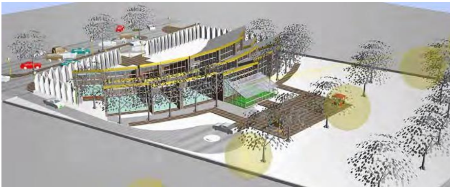
Fig. 52 a - L'articolazione planimetrica di questa scuola materna, qui visibile nella fase di studio preliminare, adottata anche per ridurre la superficie della parete Nord ed aumentare la superficie di quella rivolta a Sud, ha comportato elevati consumi di energia integrativa per riscaldare le deviazioni estreme. Esse formano un angolo di 45° rispetto al meridiano. (Progetto Giorgio Bedin - Luca Feltrin)
