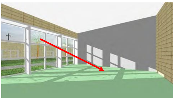
Fig. 74 - La presenza di schermature solari regolabili interne alla finestra in questa aula di scuola elementare devia gli utili raggi solari invernali verso il soffitto del vano, lasciando passare solo quelli inferiori che colpiscono direttamente il pavimento.
