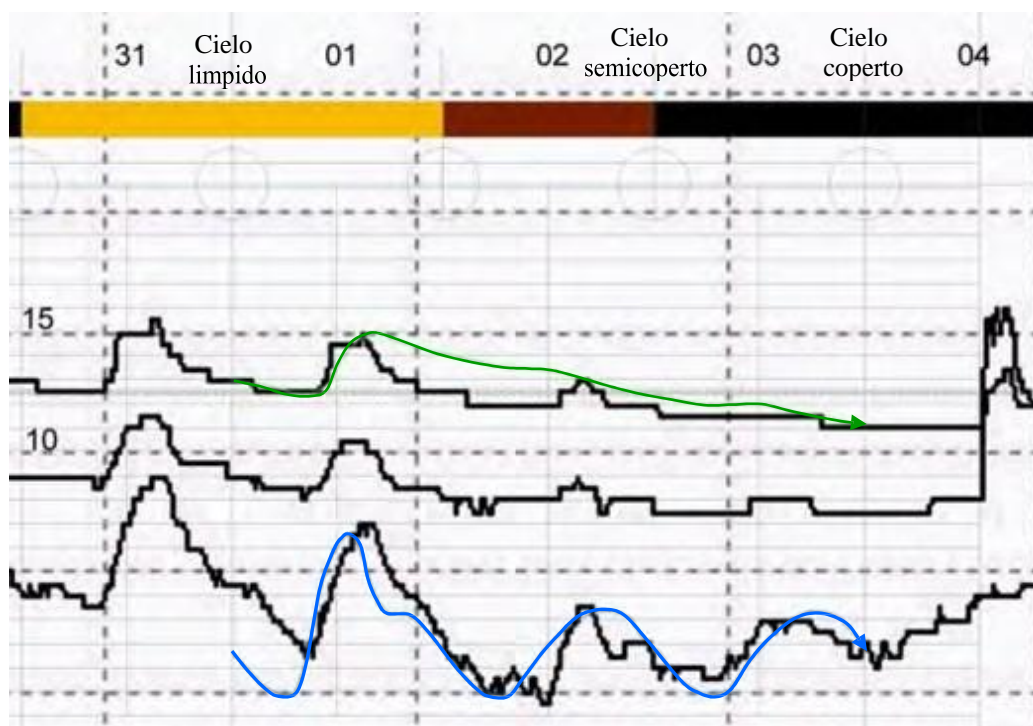
Fig. 93 - Nella scuola media Giovanni XXIII, il rilievo delle temperature, esterna (inferiore), interna (superiore) e dell'aria di ricambio in ingresso (intermedia) dal 22 dicembre 2007 al 4 gennaio 2008, in un'aula, ha consentito di verificare la coerenza tra i dati reali di rilievo, con quelli simulati dal computer. Nella parte ingrandita che riguarda tre giorni, 1-2-3 gennaio, la sovrapposizione dei diagrammi delle temperature esterne simulate (blu) e delle temperature interne simulate (verdi) si sovrappongono a quelle reali con una approssimazione accettabile. La temperatura iniziale di soli 13°C è dovuta al continuo funzionamento del ventilatore per il ricambio dell'aria, regolato alla massima portata, che ha abbassato costantemente la temperatura iniziale, pari a 21°C, del periodo. La temperatura dell'aria in ingresso per il ricambio si attestava sempre in posizione intermedia, segnalando un recupero di calore di circa il 60%.
