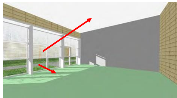
Fig. 74 - La presenza di schermature solari regolabili interne alla finestra in questa aula di scuola elementare devia gli utili raggi solari invernali verso il soffitto del vano, lasciando passare solo quelli inferiori che colpiscono direttamente il pavimento.
