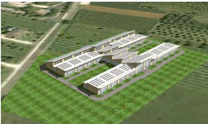
Fig. 37 - La vista da Sud - Ovest di una scuola elementare mostra le ampie superfici vetrate esposte a Sud delle aule, della sala centrale polivalente e delle stanze di servizio poste lungo il lato Nord.
