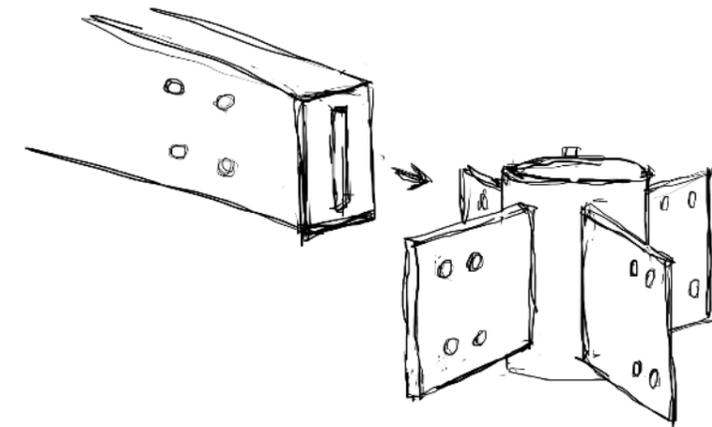
Il rivestimento della struttura è formato da pannelli di legno uniti tra loro attraverso una cornice, la quale viene posizionata sopra il telaio e fissata grazie a spine di legno che ne permettono l'incastro con i fori già presenti nelle travi. Questo sistema garantisce un veloce e semplice montaggio/smontaggio.
