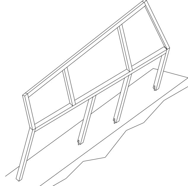
**5.** Дополнительные ребра жесткости привариваются с произвольной привязкой.
