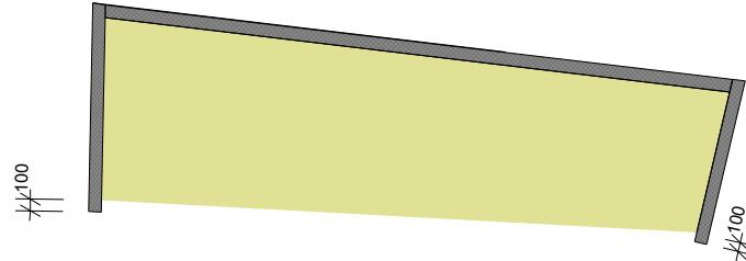
**2.** Каждый фрагмент по трем сторонам периметра (кроме низа относительно чертежа) обваривается квадратной трубой 100 x 100 мм. Боковые части каркаса делать длиннее на 70 - 100 мм для последующей зарезки по месту.
