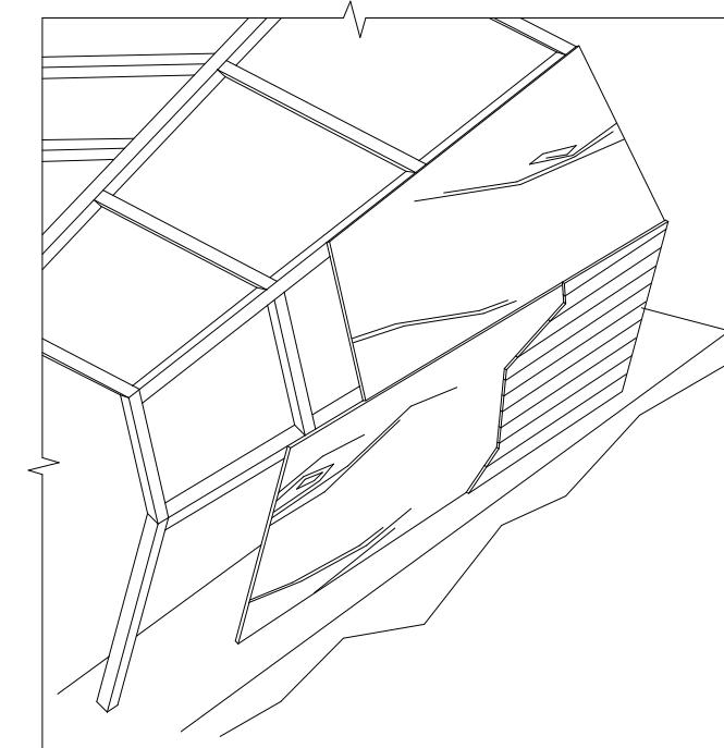
**6.** Готовый каркас облицовывается влагостойкой фанерой, дополнительно пропитывается гидрофобным составом, облицовывается лиственничным планкеном согласно чертежу (см фасады). Планкен пропитывается гидрофобным составом, Швы герметизируются силиконовым герметиком белого цвета.
