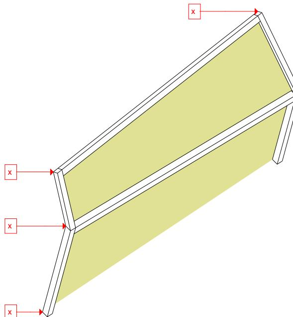
**4.** Следующая деталь устанавливается согласно привязки точек - нижние выпуски подгоняются по длине и углам.
