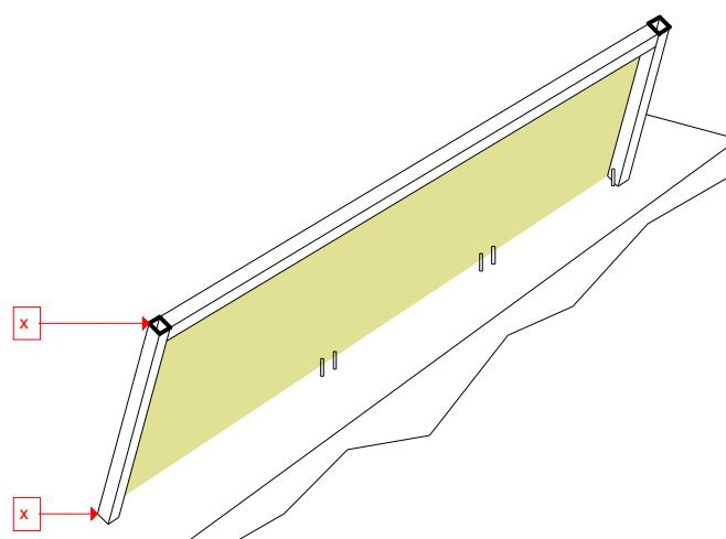
**3.** Деталь каркаса устанавливается по привязке так, чтобы пронумерованные точки оказались на внутренней грани детали. Нижние детали устанавливаются на монолитное основание и привариваются к выпускам.
