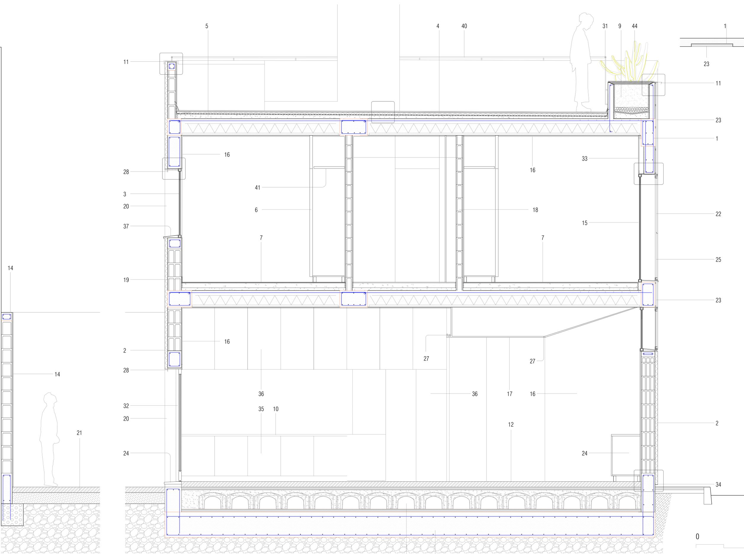
1. Muesca para carpintería en fachada chapada de hormigón encofrado con tablas verticales
