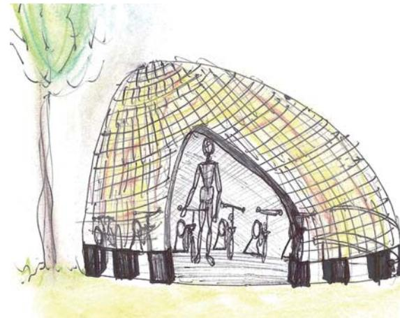
L'idea del progetto è quella di creare un'architettura minimale e essenziale, di forma ovale, interamente in legno e ricoperta di scandole.
