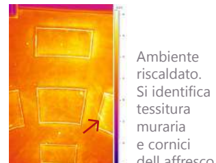
Ambiente riscaldato. Si identificano temperature diverse nell'affresco.
