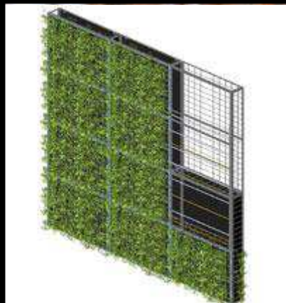
MURO INTENSIVO (continuo)
