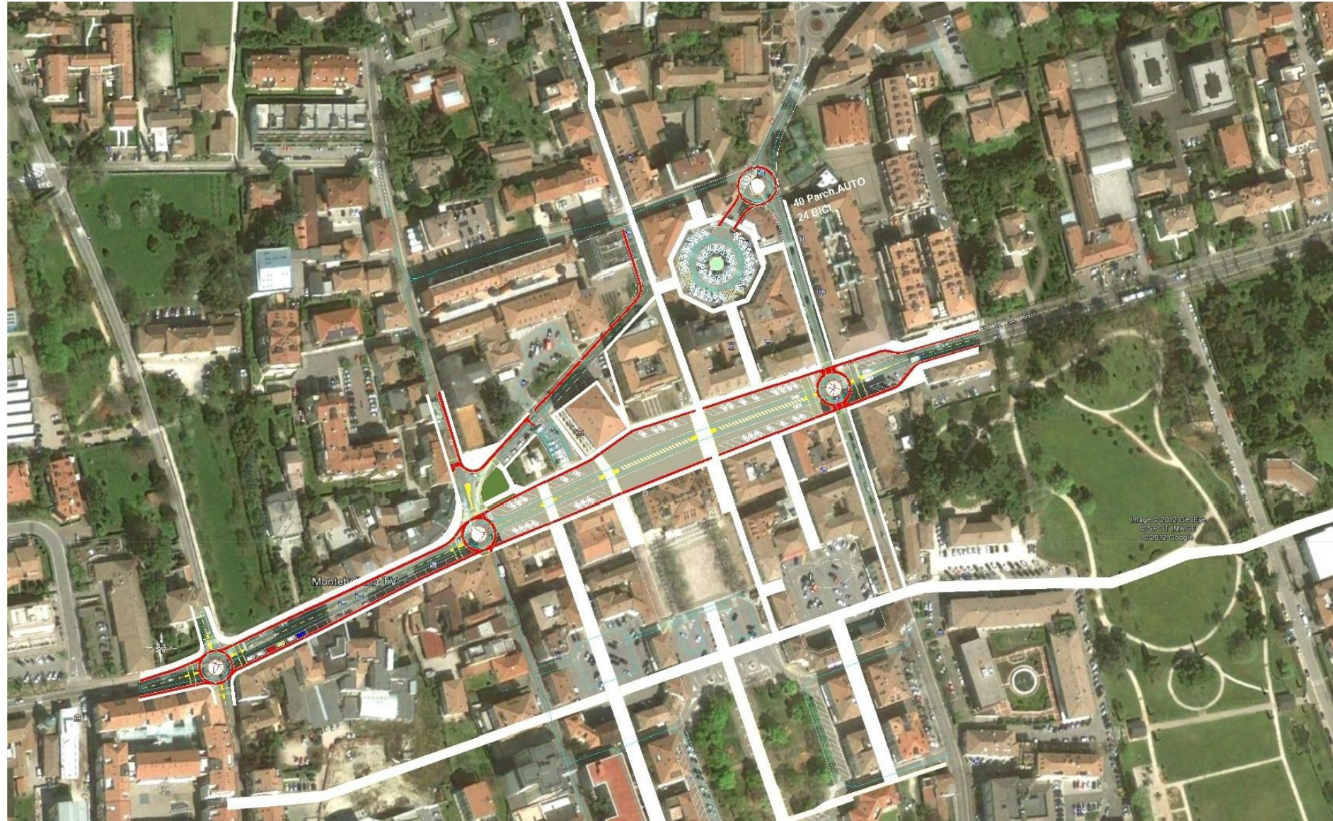
SISTEMAZIONE DI CORSO MAZZINI - VIA XXX APRILE, CON LE TRE MINIROTORIE DA 19 mt. DI DIAMETRO E SPAZI CICLABILI NEI DUE SENSI DI MARCIA. ZTL TRA LE DUE ROTATORIE ESTERNE E PEDONALIZZAZIONE DI VIA DANTE ALIGHIERI E DI VIA TRIPOLI
