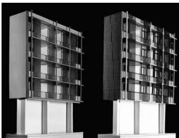
Figura 11. Plastico del nuovo involucro progettato (non realizzato) nel 1991-92 dagli architetti Burkhalter & Sumi per il complesso del Triemli-Spital di Zurigo risalente agli anni Sessanta.
