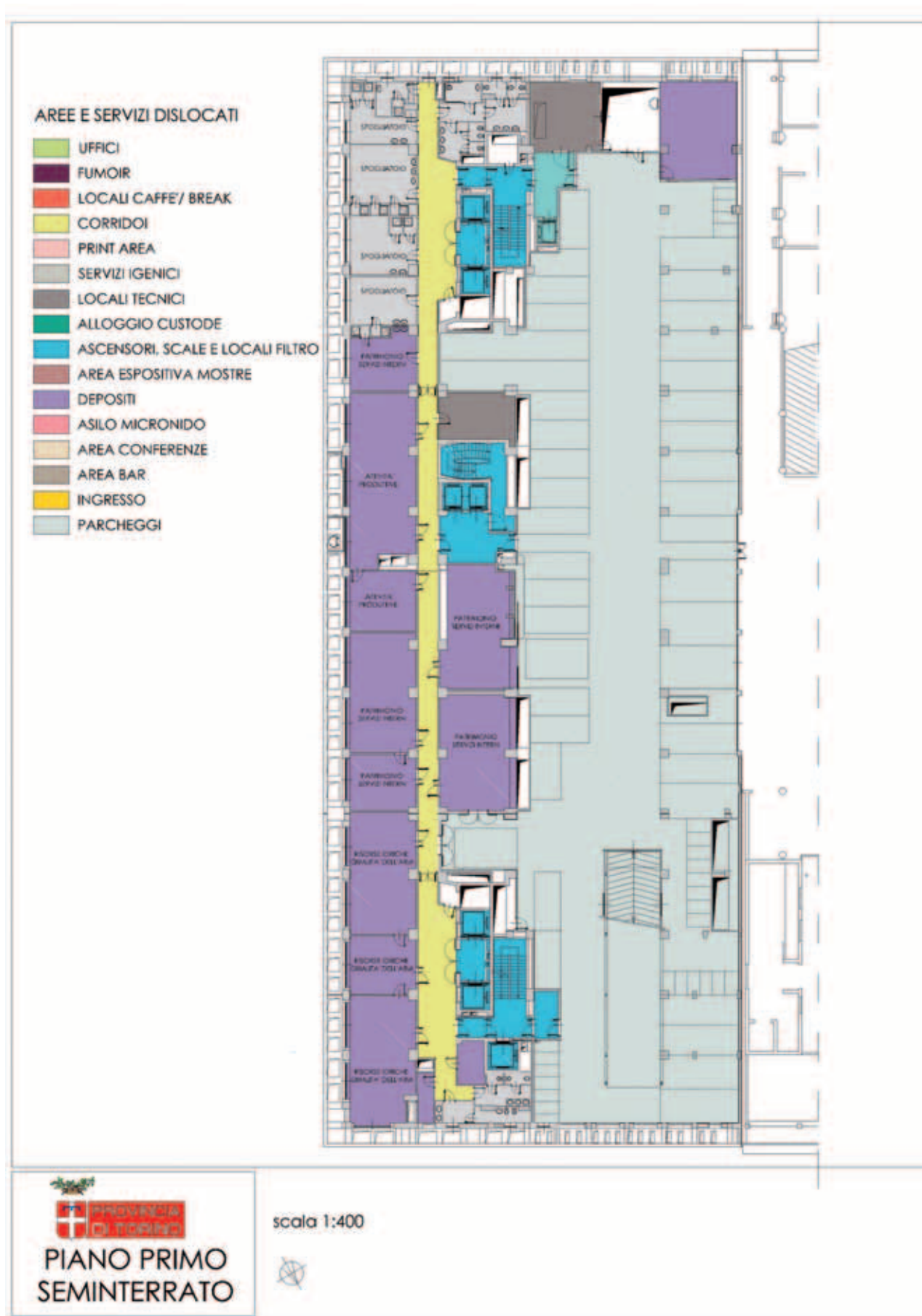
Figura 16. Nuova sede della Provincia: pianta del piano primo interrato: magazzini, parcheggio, mensa, impianti e servizi; copyright Studio Rosani.
