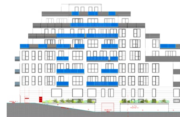
Facciata attiva - Prospetto sud con balconi vetrali fotovoltaici
