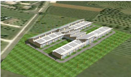
Fig. 7 - Una visione d'insieme della scuola, con esposizione a Sud delle aule ed i pannelli fotovoltaici sulla copertura
