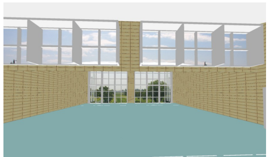
Fig. 4 - La centrale sala polivalente, come tutte le aule, è completamente ombreggiata nei mesi estivi dai frangisole fissi.
