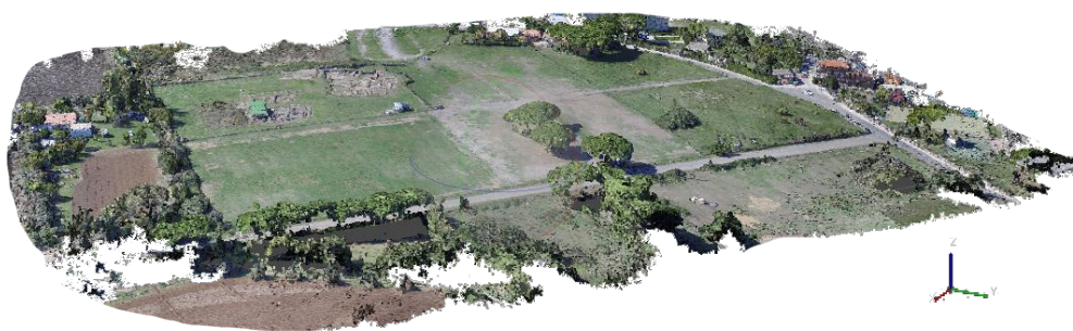
Fig. 3.31 - Nuvola densa ripulita della copertura del santuario settentrionale (elaborazione di Raimondo Caruana).
