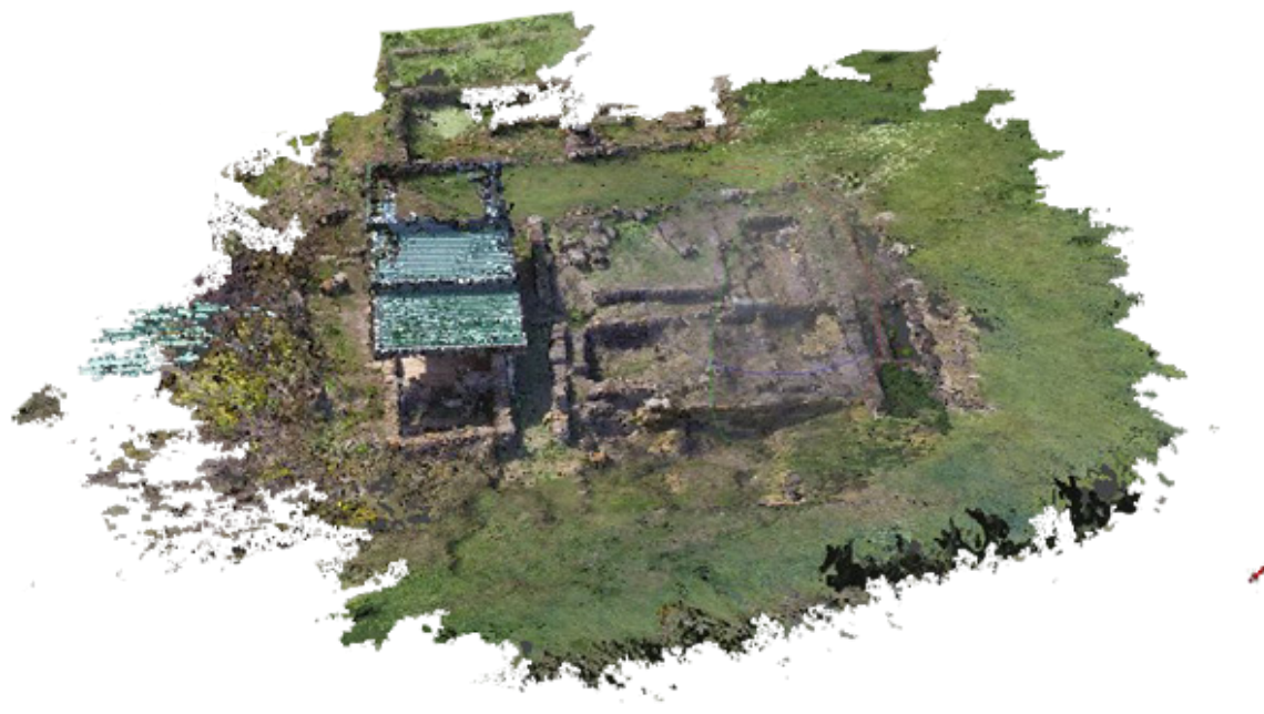
Fig. 3.23 - Acquisizione nuvola sparsa della copertura del santuario (elaborazione di Raimondo Caruana).
