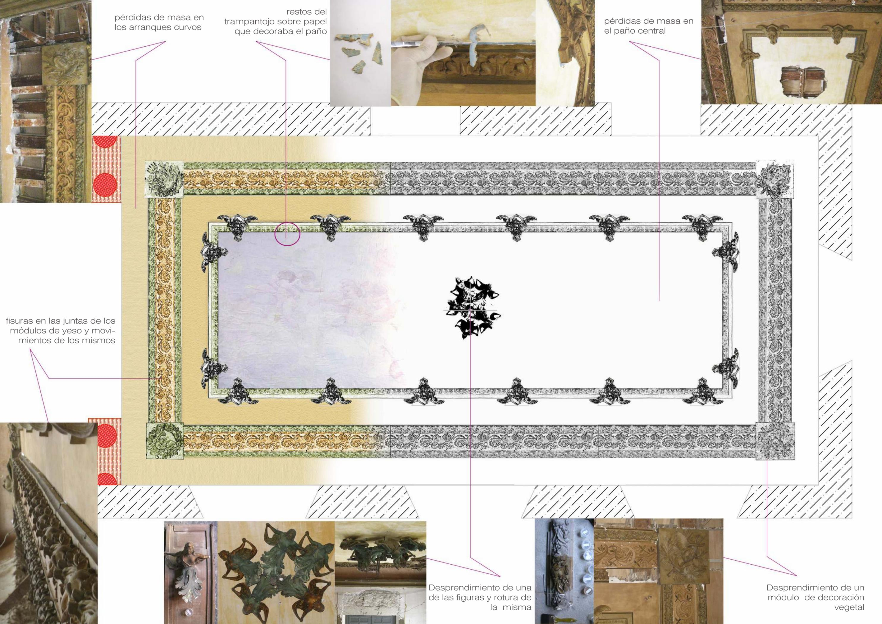
fisuras en las juntas de los módulos de yeso y movimientos de los mismos
