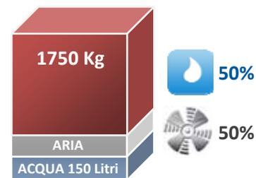
I pori d'aria sono riempiti d'acqua per il 50%. In questo caso il grado di penetrazione dell'umidità è del 50%.
