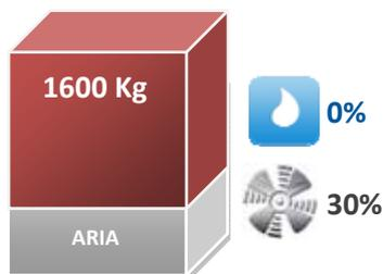
1 m<sup>3</sup> cubo di muro in mattoni contiene circa 1600 Kg di peso solido. Circa il 30% del suo Volume è composto da pori d'aria.
