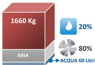
I pori d'aria sono riempiti d'acqua per il 20%. In questo caso il grado di penetrazione dell'umidità è del 20%.
