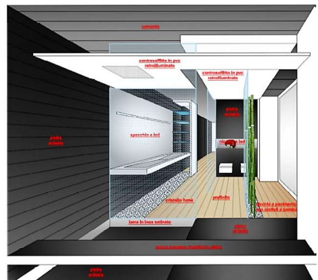
Sotto: bagno della camera padronale visto dalla doccia; disegno esecutivo con specifiche dei materiali realizzato con software Autodesk-AutoCAD a cura dell'Arch. Guarneri, 2013.
