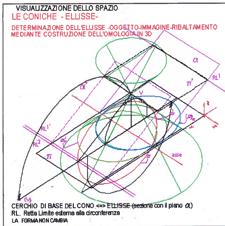
Fig. 30 Superficie conica a due falde. Rappresentazione assonometrica dell'ellisse ottenuta sul piano di sezione e poi ribaltata. analisi della vera grandezza mediante ribaltamento omologico
