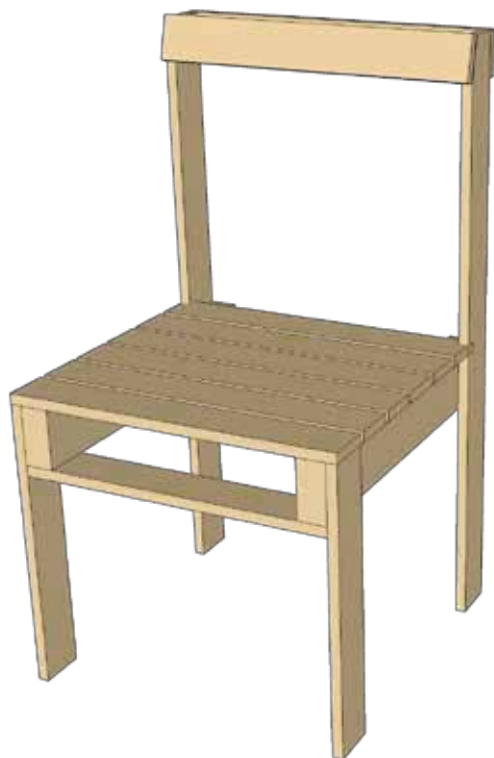
SEDIA BASE N.2 PALLET NON STANDARD DIMENSIONE OGGETTO FINITO 50x50x90 CM
