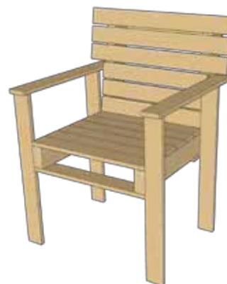
SEDIA CON BRACCIOLI N.2 PALLET NON STANDARD DIMENSIONE OGGETTO FINITO 65x50x90 CM STRISCE DI PIANI ABET PER FINITURA COLORATA
