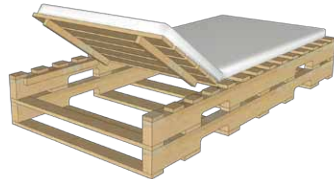
CHAISE LONGUE N.2 PALLET NON STANDARD DIMENSIONE 170x80 CM SCHIENALE RECLINABILE, CUSCINO RIPIEGABILE NELLA STRUTTURA
