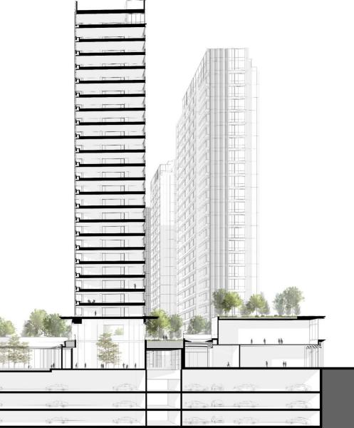
"下商上居"设计策略的主要方向,是打造向上 生长、向外延展的无界生活场景。与一般封闭式 小区做法不同,项目直接将城市道路设置在架空 层之间,利用狭长的地块特征,在长达近400米 的地块中设置4条7米宽通道,打通了对面商贸城 和城中村居民的互通,将项目地块与城市道路完 全相融。为了呼应城市环境,同时满足多方面的 配套需求,项目采用双首层设计:第一个首层给 城市,第二首层给住户,使居住品质和生活便利 得到最好的协调统一。
